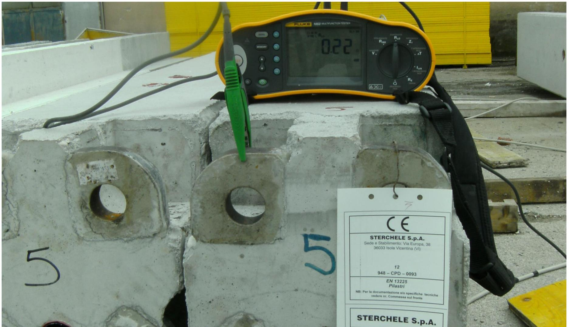
Verifica di continuità elettrica delle armature dei pilastri per il loro utilizzo come colonne montanti di conduttori di terra cui connettersi ai singoli piani.
